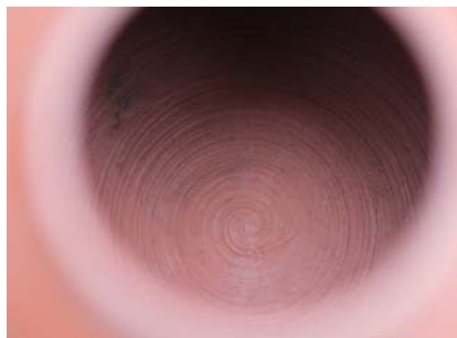
ロクロ成形による茶壺の内部。 中央部に螺旋状の模様が見えます。
