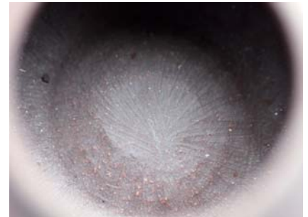
タタラ成形による茶壺の内部。 中央部から放射状に伸びる筋が見えます。
